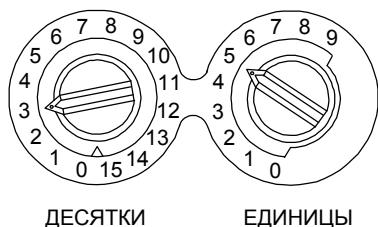
Для выставления адреса извещателя используются два поворотных переключателя. Базовое основание значительно проще установить, если адрес назначается самому устройству. В устройствах серии AP200 адреса задаются так же с помощью двух поворотных переключателей. Первый поворотный переключатель задаёт десятки, а второй переключатель задаёт единицы.
