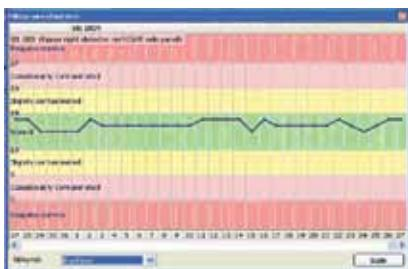
Esgraf отображает информацию о загрязнении пожарных извещателей в графическом виде. Например, раз в день, информация может считываться из извещателя и записываться в базу данных. После этого Esgraf может считать информацию о загрязнении и предоставить ее в графическом виде.
