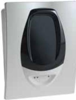
Извещатели 6500SA и 6500A – приёмопередатчики, которые можно подключить непосредственно к шлейфу. Инфракрасный передатчик генерирует луч света, направленный к высокоеффективному отражателю. Отражатель возвращает луч приёмнику, в котором проводится анализ полученного сигнала. Изменения уровня отраженного сигнала используется для формирования сигнала тревоги.
