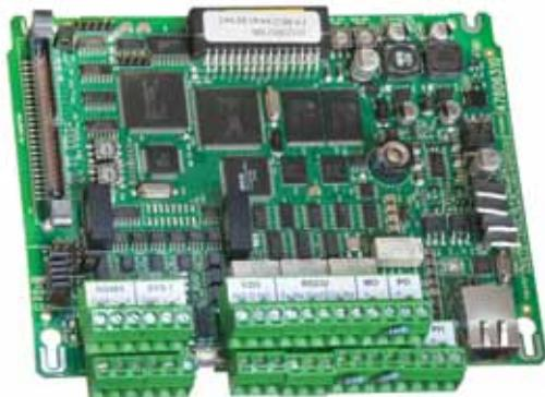
Конфигурируемый интерфейс RS-232: обновление настроек, принтер или обновление прошивки MC2, SLC и ALC.
