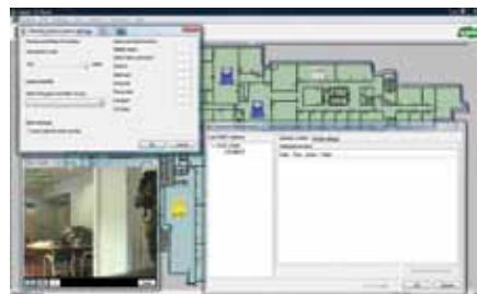
Камеры имеют окна управления, которые выглядят как обычная панель управления камеры. Наклоном, поворотом и увеличением можно управлять напрямую из Esgraf с помощью мыши или совместимого с Windows джойстика. Фиксированная камера может иметь функцию программного масштабирования. Можно активировать предварительные установки положения камеры и схемы ее движения. Тревоги, поступающие от систем, отображаются в списке событий.
