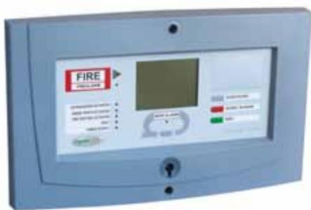
Выносная панель управления FMPX используется пожарной бригадой как основной источник информации о месте срабатывания сигнализации в здании. Панель можно использовать исключительно как дисплей, а так же для выключения и сброса пожарной сигнализации. Если требуется только выводить информацию по пожарной сигнализации в зоне, панель FMPX нужно соответствующим образом настроить. Панель FMPX можно подключать к панелям FX 3NET: FXS, FXM, FX и FXL.
