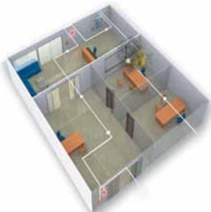
Esgraf сразу отображает на плане объекта расположение тревожных событий, полученных от систем безопасности. Одновременно, при желании, можно получить инструкции, связанные с данной тревогой и видеоизображение места, откуда поступила тревога. Также автоматически производится распечатка плана с тревогой. Кроме этого, Esgraf может направлять подробности о тревоге по электронной почте или SMS, гарантируя своевременную доставку информации в соответствующие службы.
