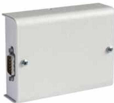
Модемный адаптер CODINET используется вместе с модемом для организации связи через последовательный порт на больших расстояниях. Стандартное расстояние между двумя локальными модемами может составлять 1 - 5 км. Адаптер CODINET рассчитан на передачу данных со скоростью 19200 бод и имеет гальваническую развязку. Вариант CODIS используется для скорости 9600 бод и не имеет гальванической развязки.
